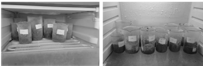
Рисунок 5 - Имитация климатических условий при температурах -30^{\circ}\text{C} , 0^{\circ}\text{C} , +30^{\circ}\text{C}
