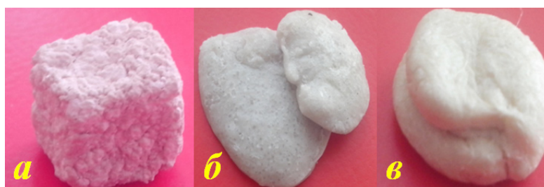
а – мел просто просеян, б – мел измельчен в агатовой ступке, в – мел измельчен и дополнительно прокален
