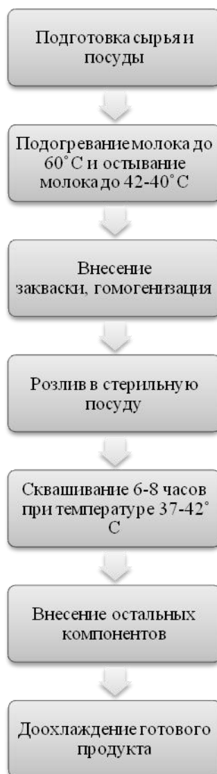
Схема 1 – Технологическая схема производства биоогурта с фруктово-ягодным наполнителем в домашних условиях
