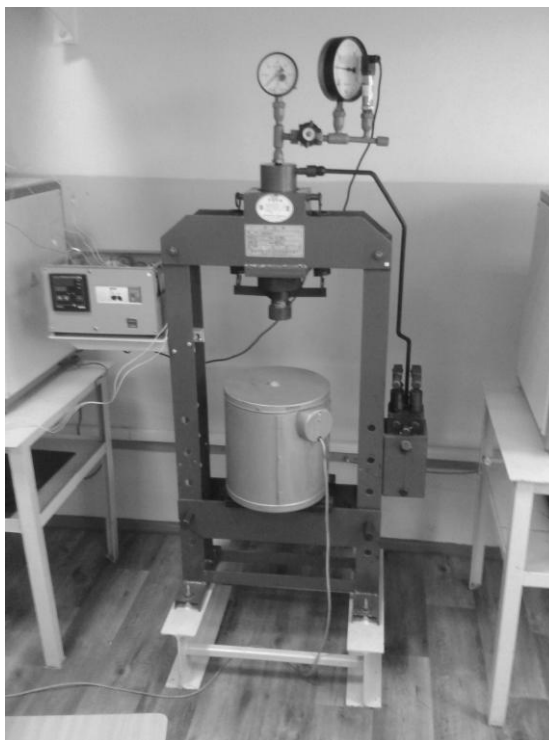
Рисунок 1 – Стенд для исследования зависимости предела прочности на сжатие от температуры
