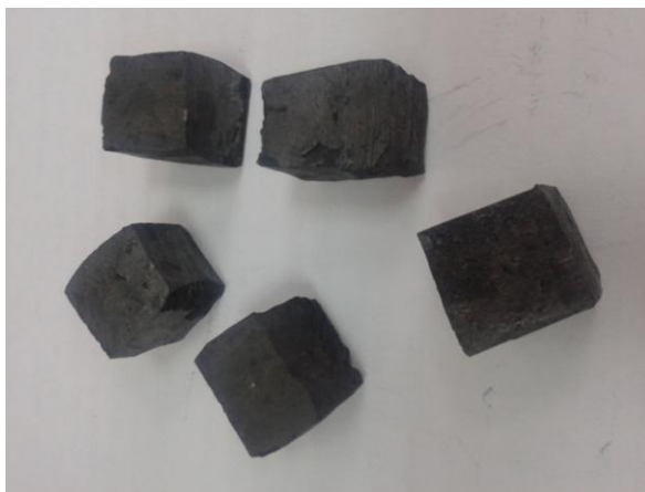
Рисунок 2 – Углеродные огнеупоры прошедшие механическую обработку. Размеры образцов \sim 2 \times 2 см
