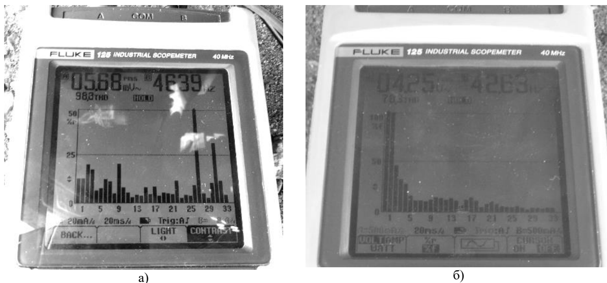
Рисунок 5 – Результаты исследования спектрального анализа на автомобиле «УРАЛ-43203» а) система неисправна; б) система исправна
